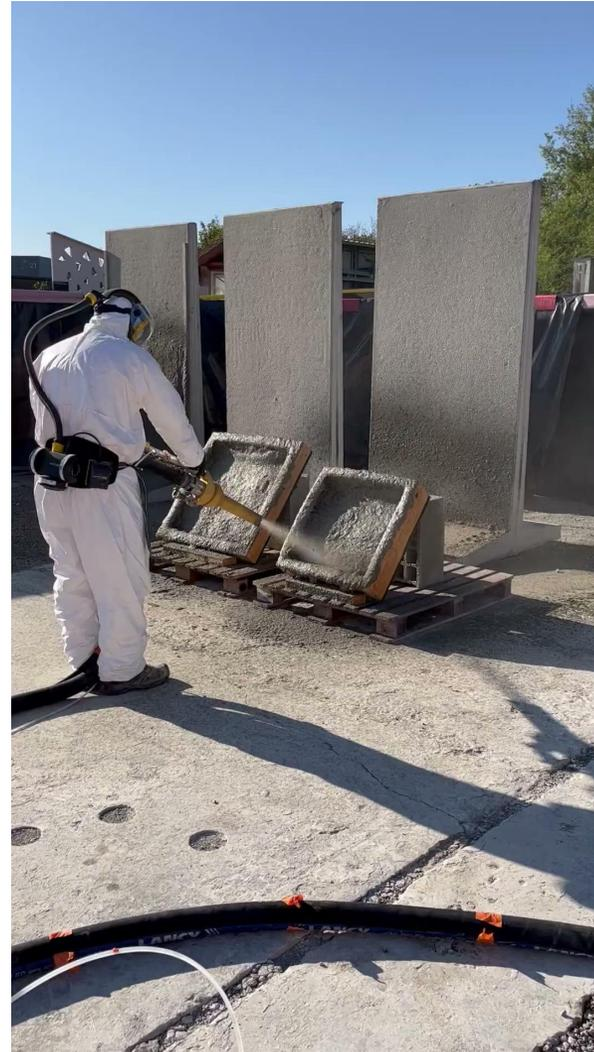
**Validation de la chaîne de production par essais échelle 1/1 (20m pompage) sur le site du Holcim Innovation Center)**
