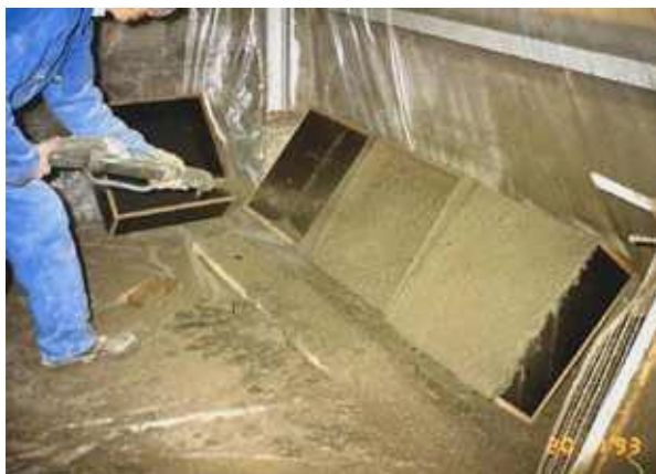
Photo n° 173 : projection dans une boîte pour essais sur éprouvettes carottées (crédit photo D. Poineau)
