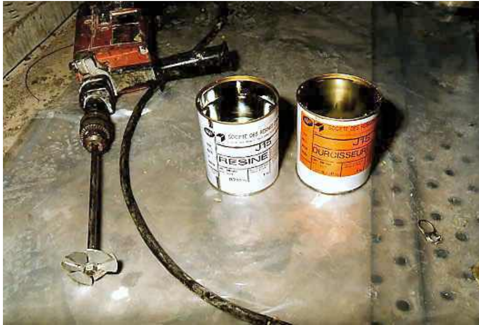
Photo n° 140 : boîtes de résines : base et durcisseur (crédit photo Freyssinet)
