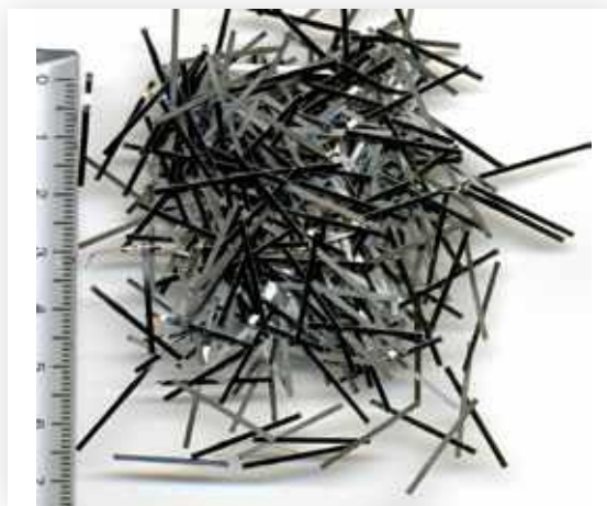
Photo n° 139 : exemple de fibres métalliques en fonte (crédit photo D. Poineau)
