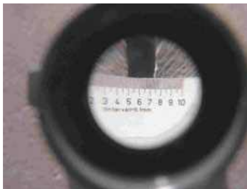
Photo n° 15 : utilisation d'un compte-fils (crédit photo Freyssinet)
