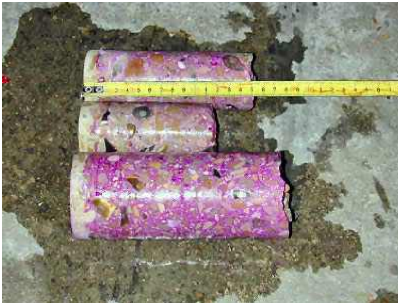
Photo n° 35 : mesure de la profondeur de carbonatation (crédit photo Lerm)
