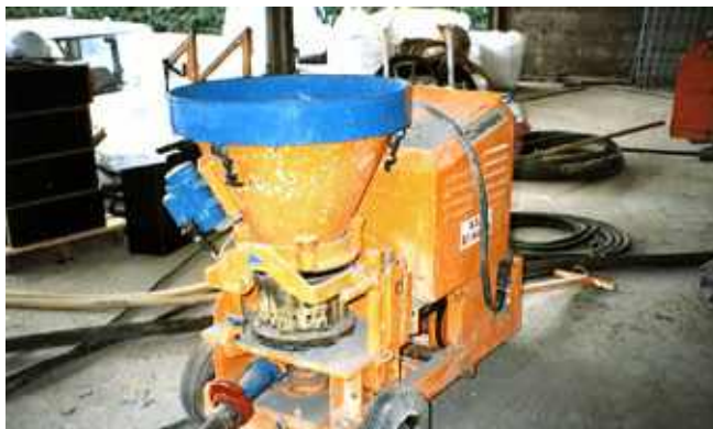
Photo n° 145 : machine à projeter le béton en voie sèche (crédit photo D. Poineau)
