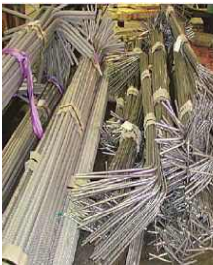
Photo n° 132 : aciers et armatures de béton armé inoxydables (crédit photo CIMbéton)
