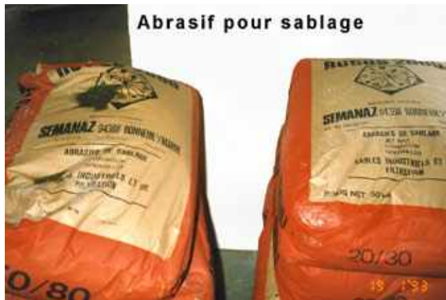
Photo n° 154 : sacs d'abrasif sans silice pour sablage (crédit photo D. Poineau)
