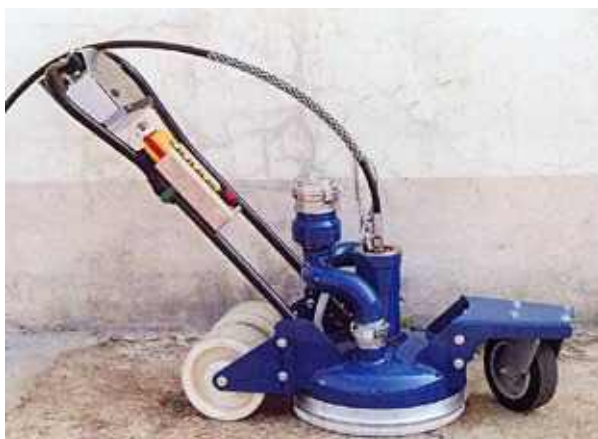
Photo n° 4 : appareil de décapage des sols (crédit photo Rivard)
