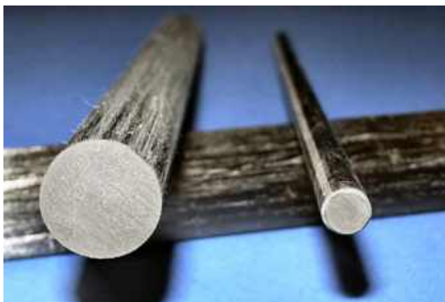
Photo n° 134 : barre PRF avec revêtement sablé (crédit photo Freyssinet)
