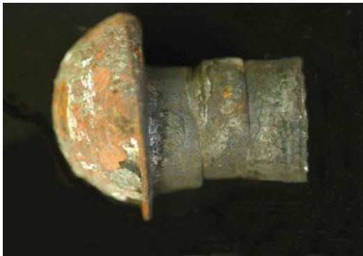
Figure 67 : Effet de cisaillement sur un corps de rivet (photo Jean-Paul PERSY).
