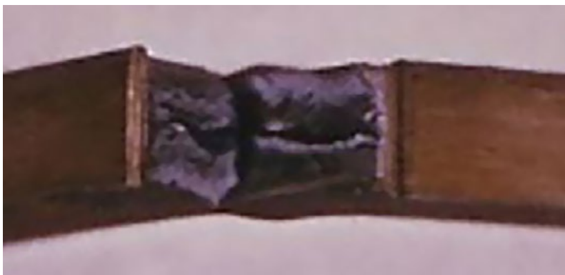
Fig. 24 : Porosité dans la masse d'un acier des années 1970 env. (photo Jean-Paul PERSY).
