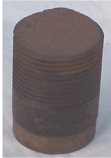
Figure 47 : Rupture plane à fond de filet sur un élément en barre (photo Jean-Paul PERSY).
