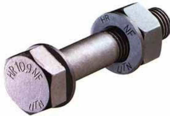
Fig. 131 : Exemple de marquage sur la tête de vis (document UTN).
