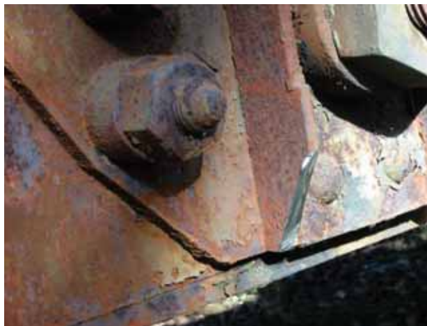
Fig. 27 : Prélèvement en extrémité de pièce pour analyse chimique et examen métallographique (photo Jean-Paul PERSY).
